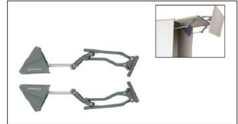
Tay nâng đôi, tải trọng 12kg, chiều rộng tối đa 1200mm, chiều cao tối đa 800mm
